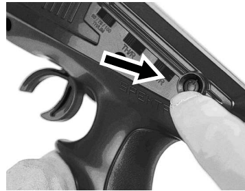
CONTROLLER ON FIRST Fernsteuerung als erstes einschalten Radiocommande en premier
